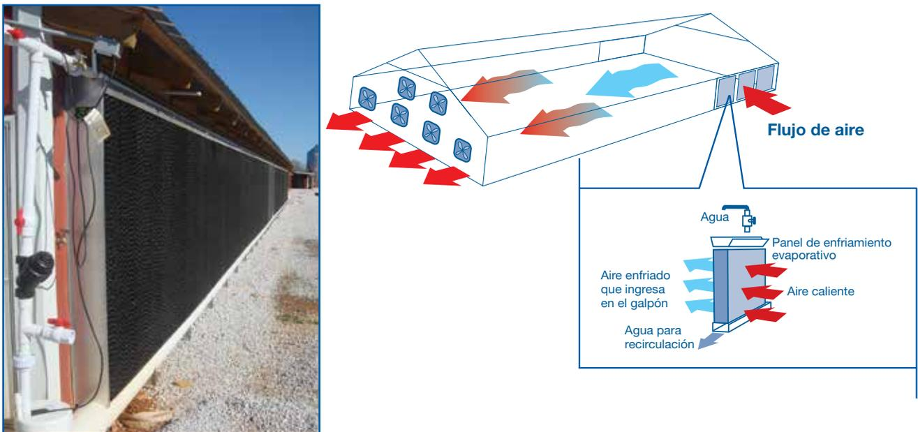
Este diseño y la disposición de los paneles de enfriamiento permiten que los grandes volúmenes de aire usados en la ventilación de túnel pasen por la superficie del panel para que se enfríen antes de ingresar al galpón.
