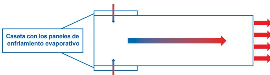
Los extractores suelen ser de 127-132 cm (50-52 in) de diámetro. Se pueden instalar en la pared de un extremo, en las paredes laterales al fondo del galpón, o en ambos lugares. Sin embargo, cuando se instalan los ventiladores, deben ubicarse de la manera más simétrica posible (**Figura 6.13**).
