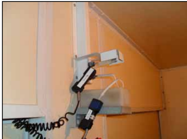
Фигура 7: Калибриране чрез поставяне на детектора за калибриране до температурния сензора на машината.
