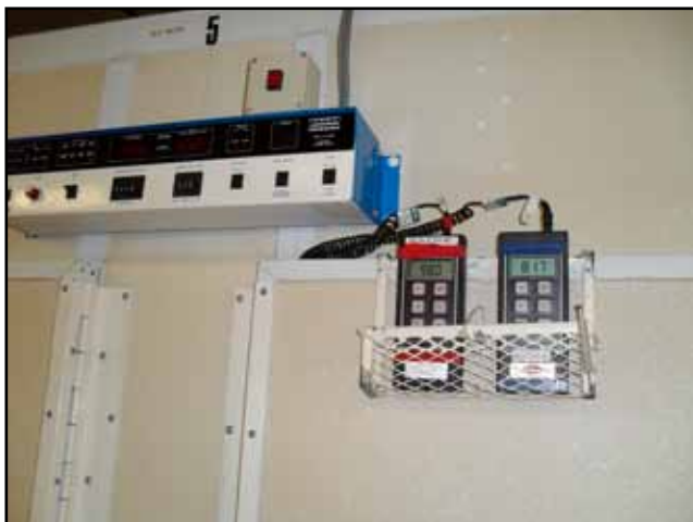
Фигура 7: Калибриране чрез поставяне на детектора за калибриране до температурния сензора на машината.
