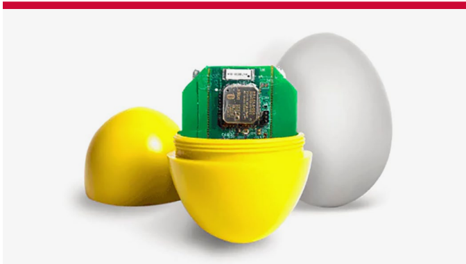
FIGURA 2: Un uovo artificiale con un sensore di forza G all'interno ( cracklessegg.com ).
