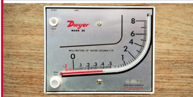
Рисунок 6.9 Манометр, используемый для контроля давления воздуха в птичнике (показания манометра соответствуют 3,8 мм водяного столба [37,5 Па]).
