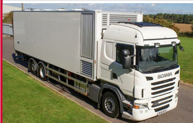
Рисунок 2.1 Типичный автотранспорт с контролируемым микроклиматом для перевозки цыплят.
