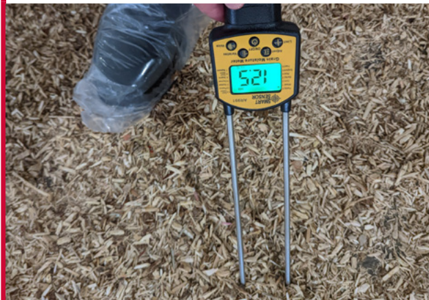
Рисунок 6.32 Измерение влажности подстилки.
