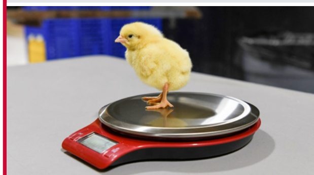
Рисунок 3.8 Электронные платформенные весы для индивидуального взвешивания птиц в возрасте до 7 дней.
