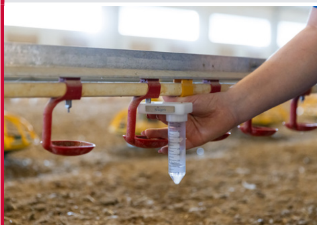
Рисунок 5.6 Измерение напора воды в ниппельной линии поения.
