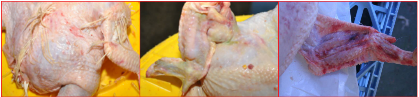
Figura 10: Ejemplos de un mal pelado, alas fracturadas y moretones asociados con el proceso de pelado.
