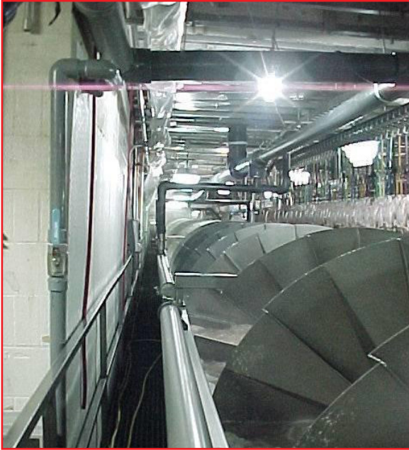
Figura 14: Ejemplos de sistemas de inmersión en agua y enfriamiento por aire.
