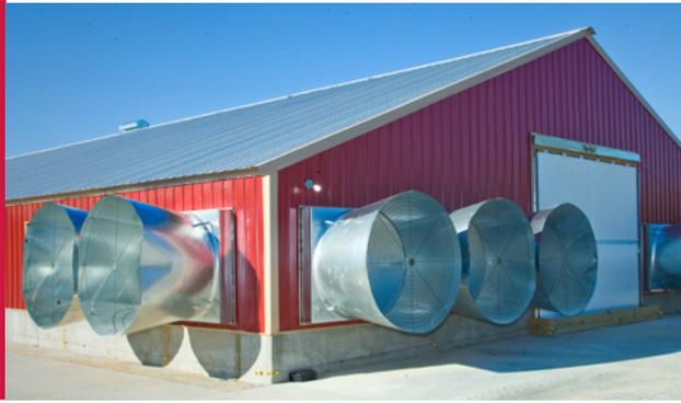
El sistema utiliza ventiladores (generalmente de 122 cm [48 in] o más) en un extremo del galpón y ventilas en el otro extremo. Se ingresan grandes volúmenes de aire que recorren toda la longitud del galpón, lo que crea una velocidad del aire a lo largo del galpón e intercambia el aire de su interior en un tiempo breve (**Figura 108**).
