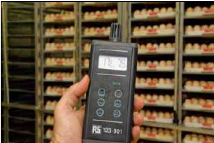
Figura 11: Revisión del ambiente del almacén de huevo usando un sensor de temperatura y humedad.
