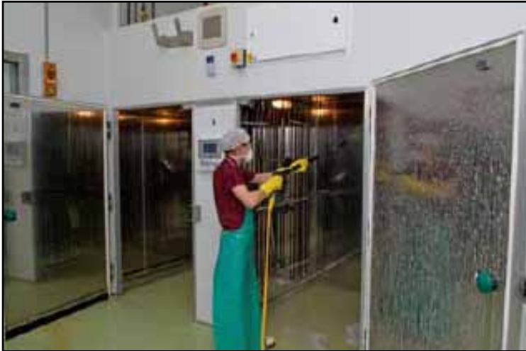
Figura 12: Uso de un sistema de lavado de baja presión para limpiar una incubadora.
