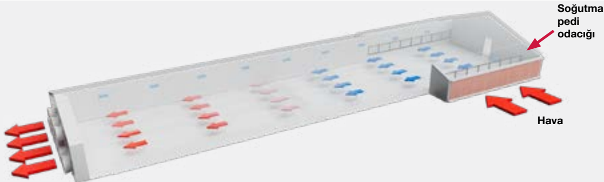
Şekil 6.18 Tünel havalandırılmalı bir kümeste hava akışı.
